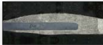
Afbeelding 7. Doorsnede van een CMT soldeerlasverbinding, foto: Institut für Schweißtechnik und Fügetechnik (ISF) der RWTH-Aachen.
