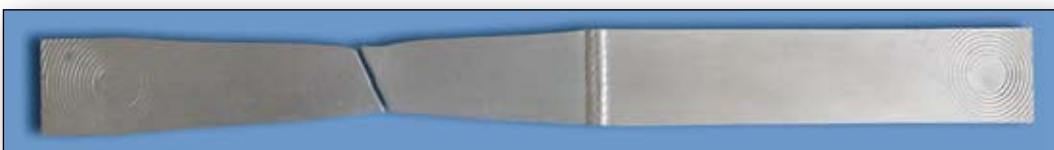
Afbeelding 6. 1,2 dik staal, 1,5 dik alu, breuk in het staal, foto: Voestalpine, Austria.
