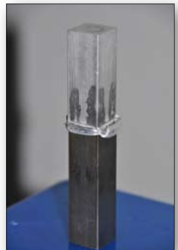
Afbeelding 3. Wrijvingslassen aluminium aan staal, foto: Saffir, Designers for Manufacturing.
