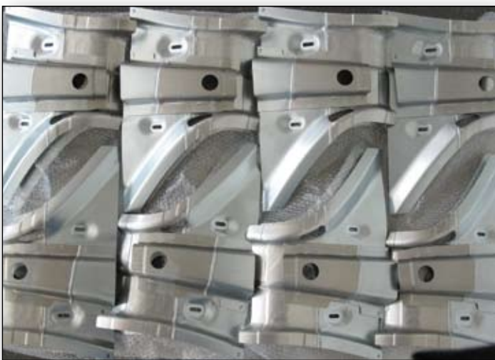
Afbeelding 5. CMT-soldeergelaste hybrideblank staal/aluminium, bron: Voestalpine, Austria.
